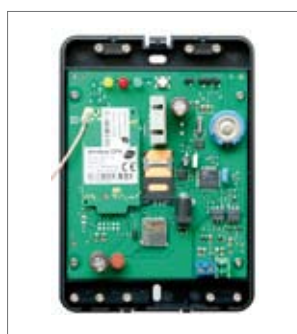
Коммуникационный модуль GPRS 850GP Модуль беспроводной связи с использованием технологии GPRS
