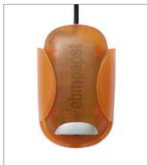
Коммуникационный интерфейс с ПК 850USB Для обеспечения связи между ПО LabVision и блоком управления
